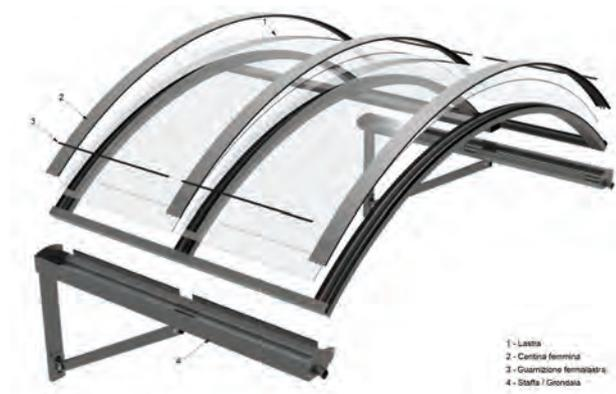
Pensilina modello TUNNEL CON PUNTONE realizzata con profili in lega d'alluminio UNI 6060 T5 verniciato a polveri poliestere e lastre di copertura modulari in polycarbonato compatto spessore 4mm. con guarnizioni di tenuta e profili fermalastre. Completa di staffe di fissaggio a parete con puntone inferiore e grondaia in alluminio con scarico acqua anteriore. Certificata da TÜV per carichi fino a 170daN/m<sup>2</sup>.
